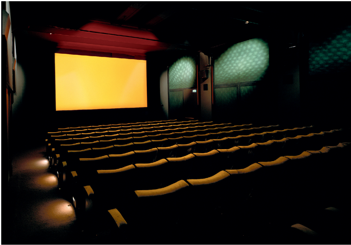
Grosser Kinosaal mit Akustikabsorbieren als Wandbild
