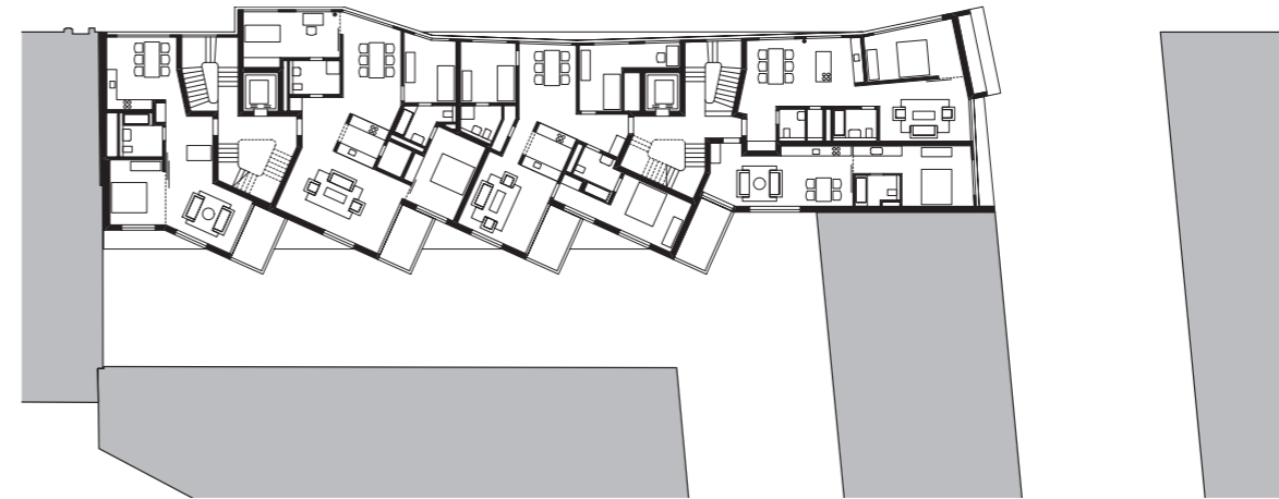
GRUNDRISS 1. OBERGESCHOSS MIT WECHSEL DER TREPPENANLAGE
