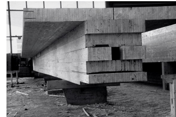
Untergurt mit Kanal für Vorspannkabel
