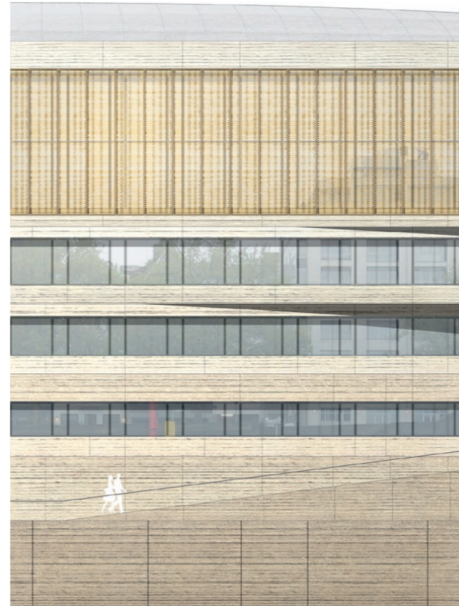
FASSADENSTUDIE FÜR DIE AUSBILDUNG VON «ANSCHWEMMUNGSLINIEN» IN DER BETONSCHALUNG
