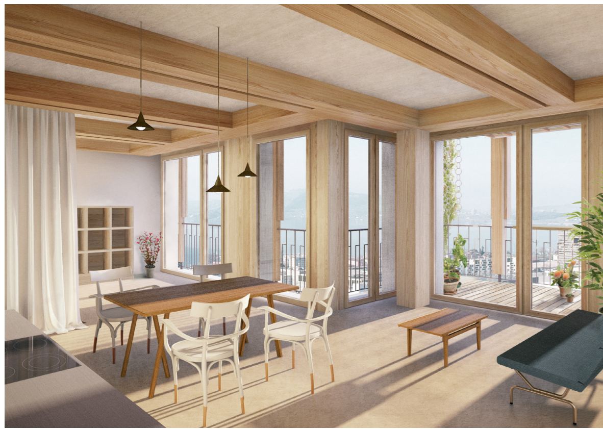
Die Holzquerschnitte der Tragstruktur bestimmen das Abstandsmass der Balkendecke mit der integriert geführten Haustechnik
